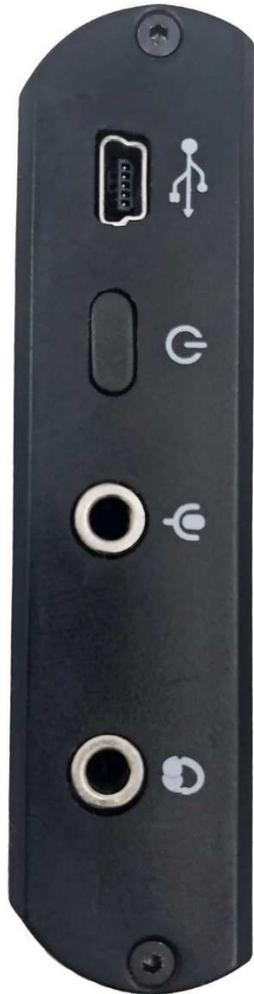
Prise mini USB permettant de recharger la batterie de l'appareil en y branchant le chargeur relié à une prise électrique
